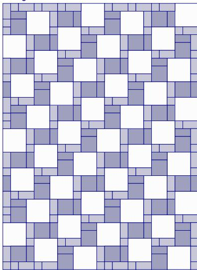
Verlegt aus Rusticano I und III im Mischungsver-hältnis 1:1. Die Platten im Kantenbereich müssen ggf. angeschnitten werden.
